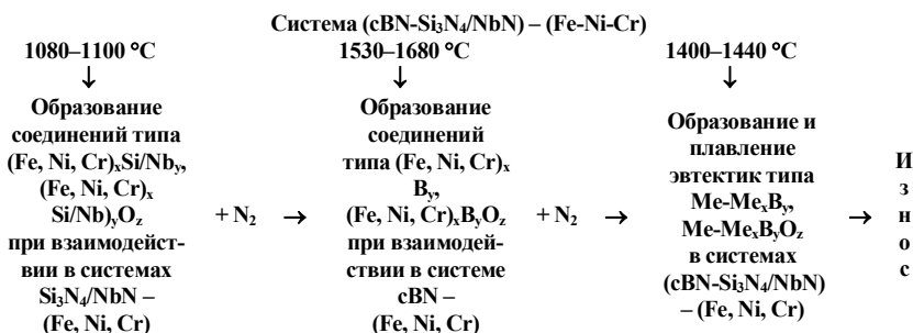
Рис. 4. Модельная схема влияния химического взаимодействия в зоне резания на износ инструмента, оснащенного ПСТМ на основе cBN
