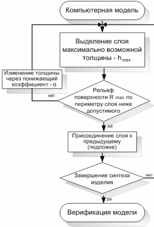
Рис. 3. Блок-схема алгоритмов разбиения на слои и сборки изделия
