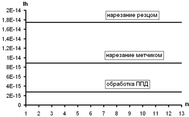
Рис. 2. Сравнительный расчет интенсивности изнашивания витков резьбы, полученной различными методами в период нормального изнашивания
