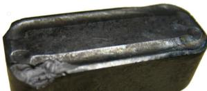
заметные вибрации и на вырубке режущая кромка почти полностью выкрошилась.
