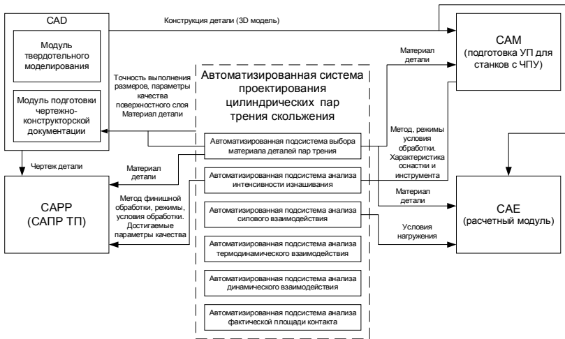
Рис. 1. Автоматизированная система проектирования цилиндрических узлов трения в составе интегрированной САПР
