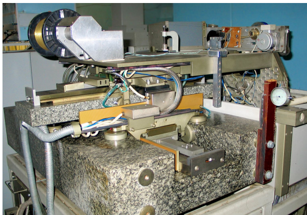
Рис. 2. Електроерозійний вирізний верстат з числовим програмним керуванням моделі СЕЛД-02
