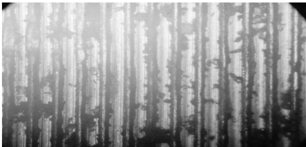
Рис. 5. Зовнішній вигляд мікронерівностей при точінні
