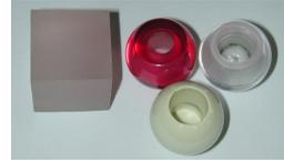
Рис. 7. Заготовки сапфира и ортопедические головки из сапфира, циркониевой керамики
