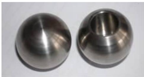
*Рис. 15. Ортопедические головки из титанового сплава системы Ti–Si–Zr*
