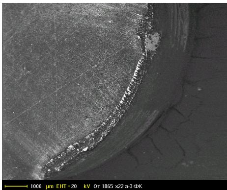
*Рис. 1. Следы налипания обрабатываемого материала при точении резцом с сечением державки 32x25 мм*
