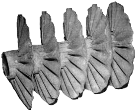
Рис. 1. Гвинтовий гофрований робочий орган
