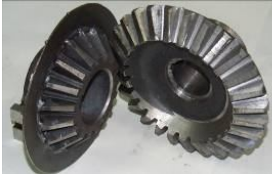
Рис. 3. Пара конічних коліс \alpha = 90^\circ
