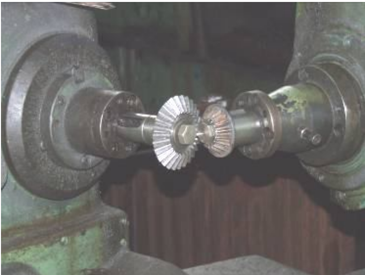
Рис. 5. Пара конічних коліс встановлена на універсальному контрольно-обкатному верстаті 5А725 ( \alpha = 35^\circ )
