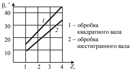
Рис. 5. Графік залежностей кута \beta від кількості зубів Z_{и} інструмента
