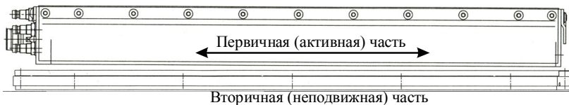
Рис. 3. Схема линейного двигателя для перемещения шлифовальной бабки станка
