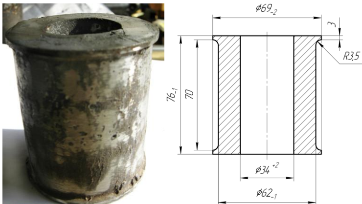
Рис. 1. Размеры заготовки детали «Втулка»
