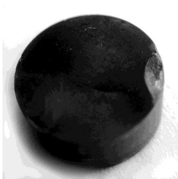
Рис. 3. Повреждение режущей кромки пластины
