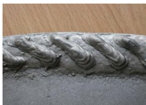
Рис. 7. Дослідний зразок диска копача зі спіроїдним шаром наплавки до експлуатації
