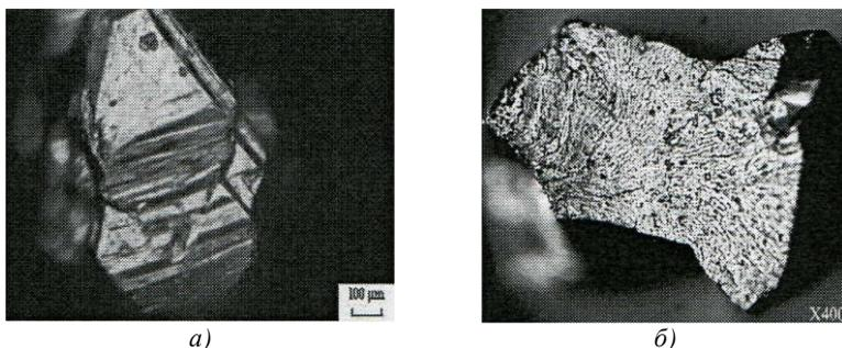
*Рис. 6. Поликристаллы на основе УДА: а) частица поликристаллического алмаза, полученная вакуумно-термической обработкой порошка алмаза детонационного синтеза; б) скол алмазного компакта, полученного ударно-волновой консолидацией порошка УДА*
