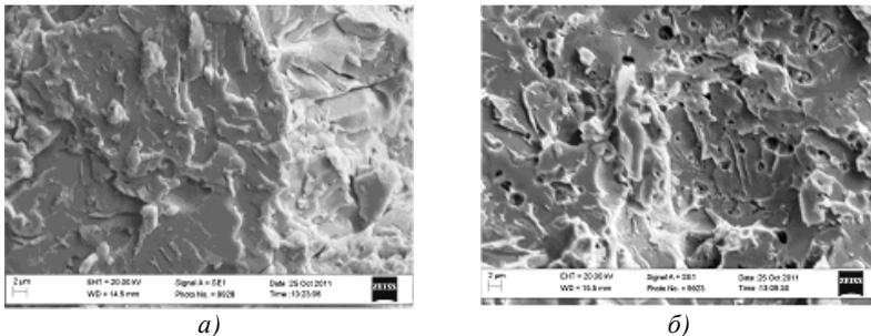
Рис. 10. Изломы композитов систем Cu+Sn+алмаз (а) и Cu+5% Cu<sub>H</sub>+Sn+алмаз (б)
