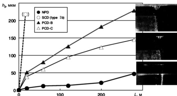
Рис. 7. Залежність износу алмазних інструментів при точенні твердого сплаву (WC 7 %) від довжини шляху різання ( $v = 20$  м/мин.;  $S = 0,1$  мм/об.;  $t = 0,5$  мм)
