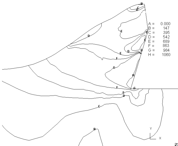
Рис. 4. Розподіл нормальних напружень у зоні різання, \gamma = 12^\circ (при T = -20^\circ\text{C} )
