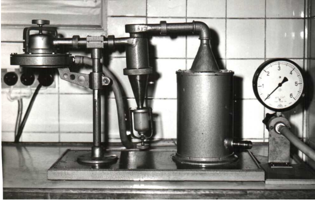
Рис. 5. Оби́щий вид установки УОА-3 для овализации алмазов
