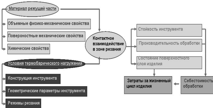
Рис. 1. Схема связей условий контактирования в зоне резания с выходными параметрами процесса обработки
