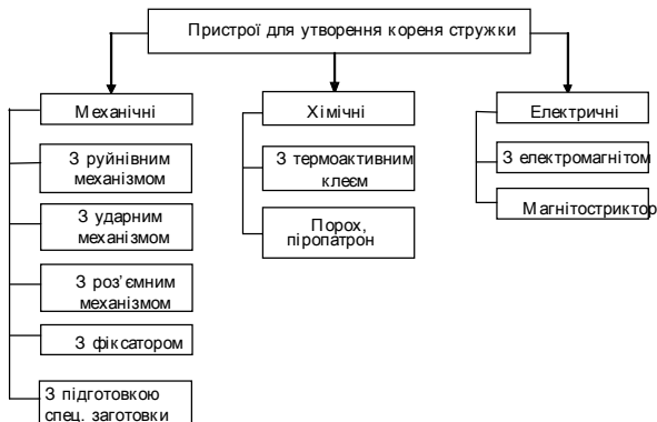
Рис. 1. Класифікація пристроїв для утворення коренів стружки за принципом дії виконавчого механізму
