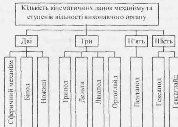
Рис. 2. Класифікація технологічного обладнання з паралельною кінематикою за кількістю кінематичних ланок та ступенів вільності
