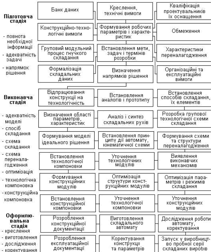
Рис. 1. Блок-схема методики проєктування конструкцій переналагоджуваних модульних складальних автоматів
