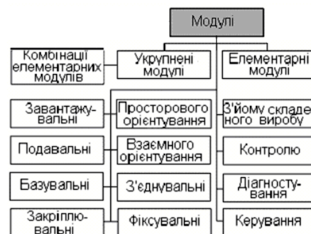
Рис. 5. Класифікація технологічних складальних модулів
