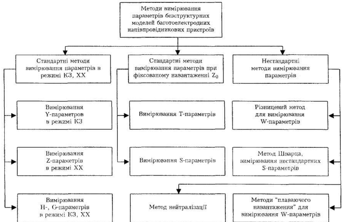
Рис. 2. Класифікація методів вимірювання параметрів безструктурних моделей багатоелектродних напівпровідникових пристроїв
