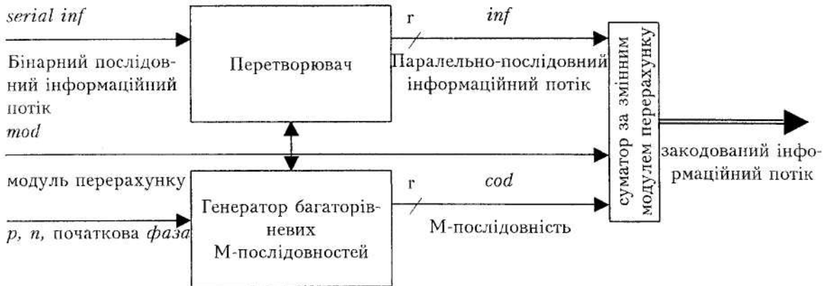
Рис. 1. Структура пристрою гамування бінарного потоку багаторівневими M -послідовностями
