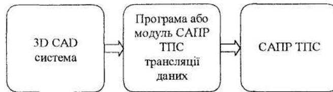
Рис. 5. Структурна схема взаємодії окремої 3D CAD, програми трансляції даних та САПР ТПС
