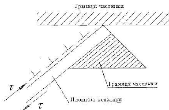
Рис. 1. Схема зародження мікротріщини.
