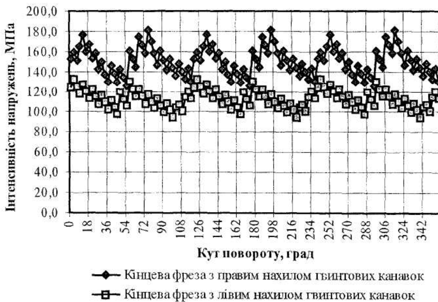
Рис. 6. Інтенсивність напружень ріжучого інструмента для випадку попутного фрезерування
