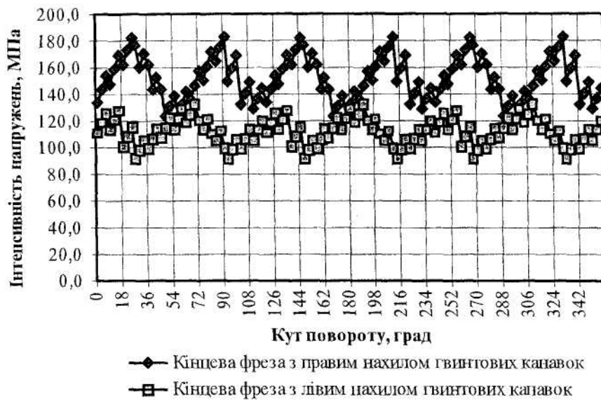
Рис. 5. Інтенсивність напружень ріжучого інструмента для випадку зустрічного фрезерування
