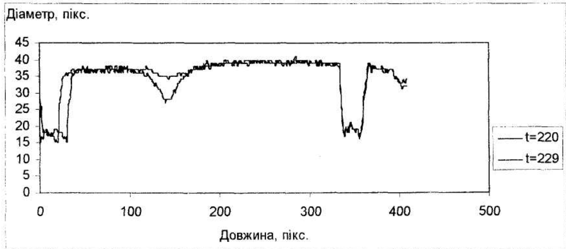
Рис. 3. Профілограми шийки за останні секунди перед руйнуванням
