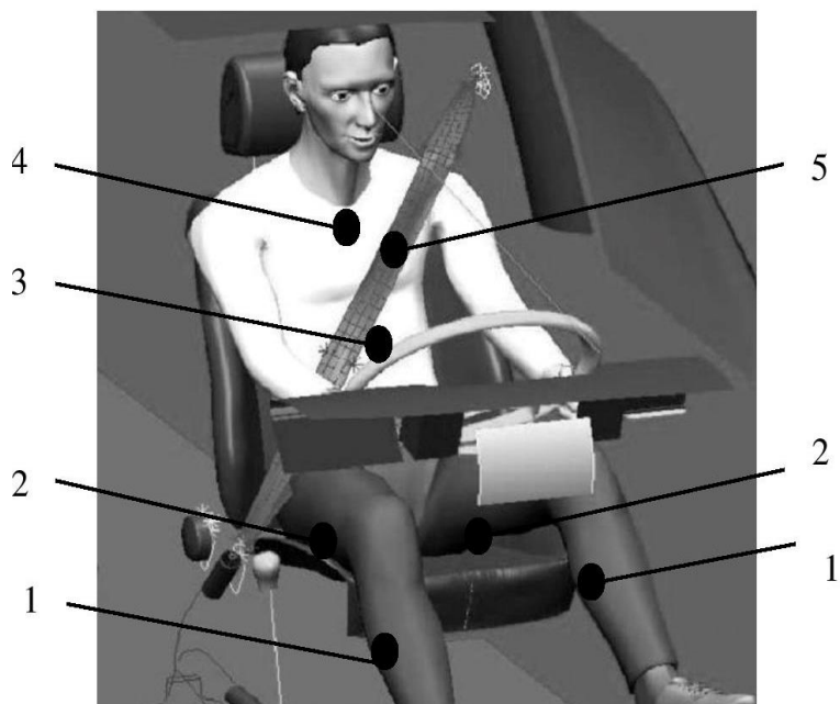
Рис. 2. Принцип розташування датчиків аналізу активності водія на основі манекену RAMSIS [11]
