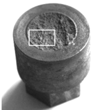
Рис. 2. Оборванный вал машины для литья пластмасс под давлением: белый контур обозначает область контроля поверхности разрушения в коронном разряде
