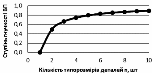
Рис. 5. Залежність ступеня гнучкості від кількості типорозмірів деталей у ВП при постійних значеннях N = 50 шт., t_{пер} = 2 хв., T_{шт} = 4,7 хв.
