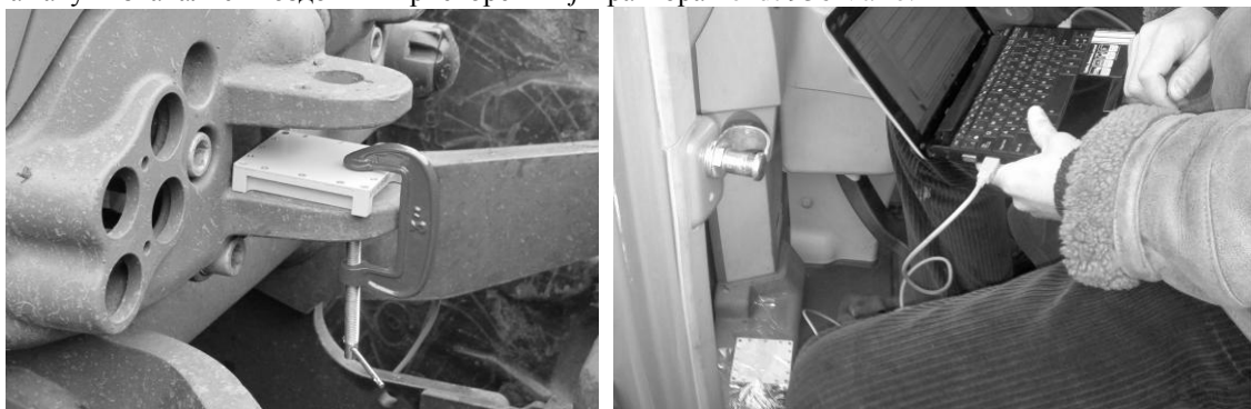
Рис. 5. Встановлення і налаштування мобільного вимірювального комплексу на тракторі Fendt 936 Vario
