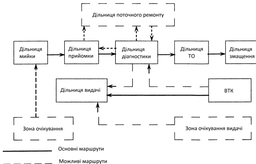
Рис. 1. Схема виробничого процесу повнооб'ємного ТО на СТО
