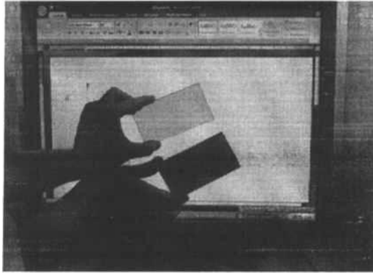
Рис. 3. Поляризація випромінювання дисплейного екрану (верхній аналізатор в положенні пропускання, нижній – «вимкнення»)
