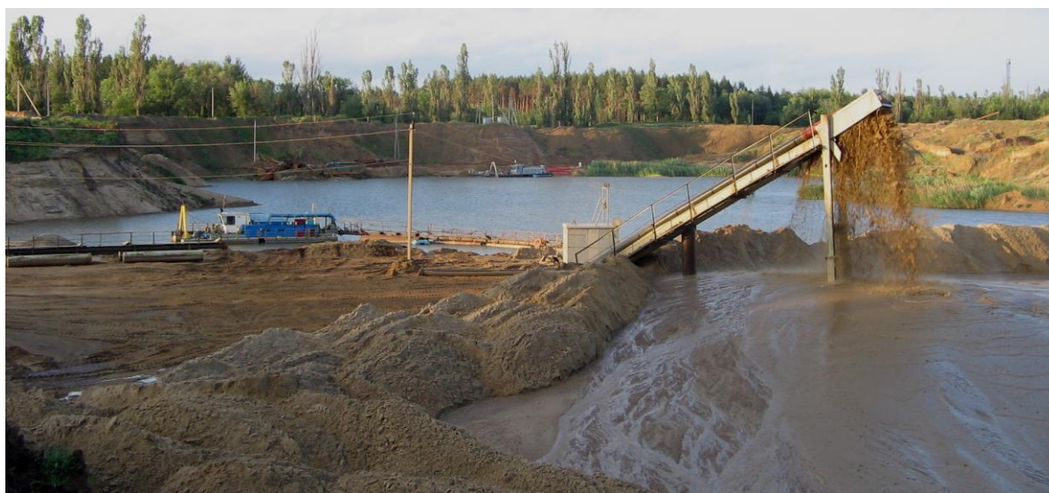
Рис. 4. Переробка піску на грохоті ГПК
