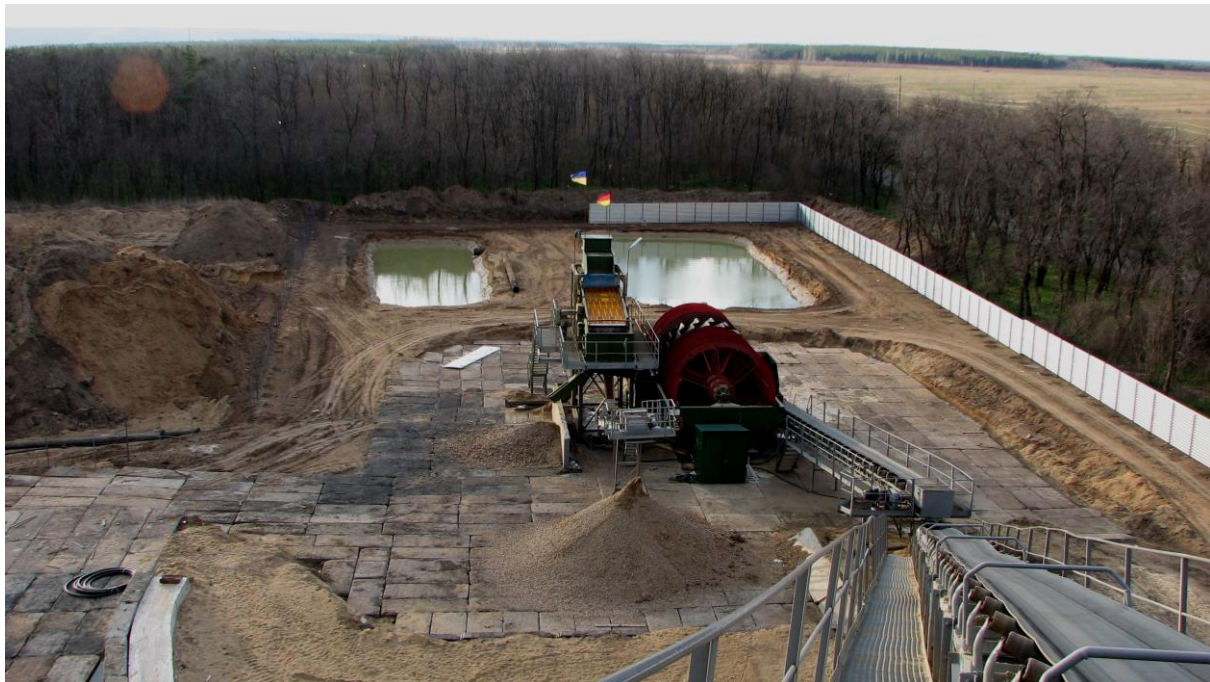
Рис. 2. Комплекс з переробки піску Олександрівського піщаного кар'єру
