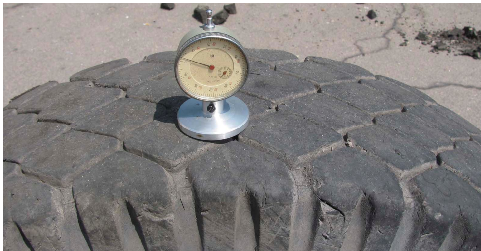
Рис. 5. Вимір залишкової висоти рисунка протектора
