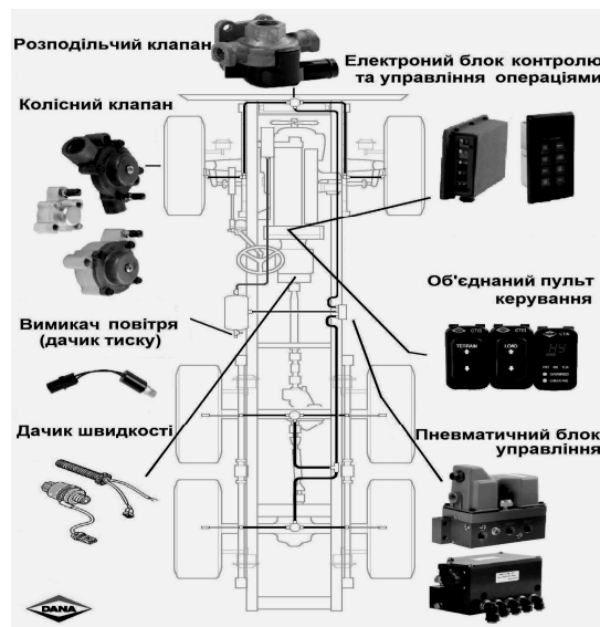
Рис. 2. Схема CTIS та модифікації її окремих елементів
