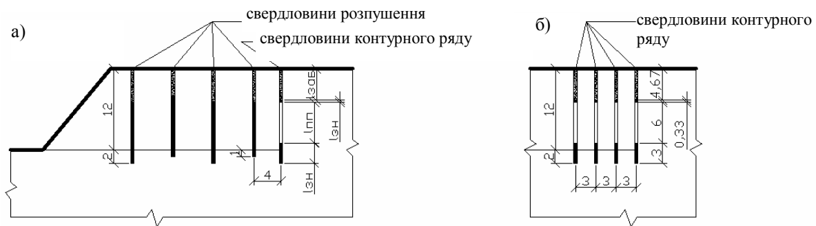
Рис. 3. Конструкція і параметри свердловинних зарядів контурного ряду: а – розміщення свердловин розпушення і контурного ряду на уступі; б – параметри контурних зарядів при d_{св} = 250 мм
