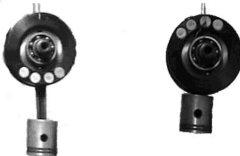
Рис. 3. Експериментальне визначення ПМІ КШМ ДВЗ Д-3
