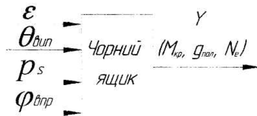
Рис. 2. Модель експерименту «чорний ящик»: \varepsilon – ступінь стиснення; \theta_{вип} – кут випередження впорскування, град. п. к. в.; p_s – тиск наддуву повітря, МПа; \varphi_{впр} – тривалість впорскування, град. п. к. в.
