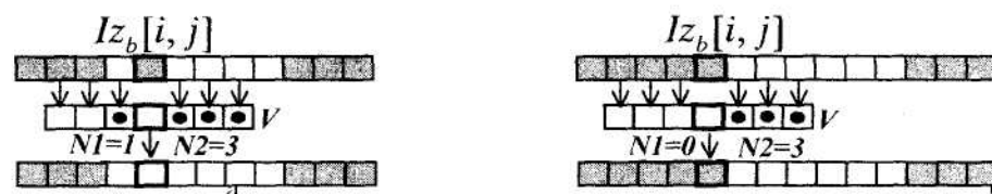
Рис. 4. Поведінка алгоритму "Заливка": а) під час корегування збійного пікселя; б) під час обробки пікселів на межі прокат/фон
