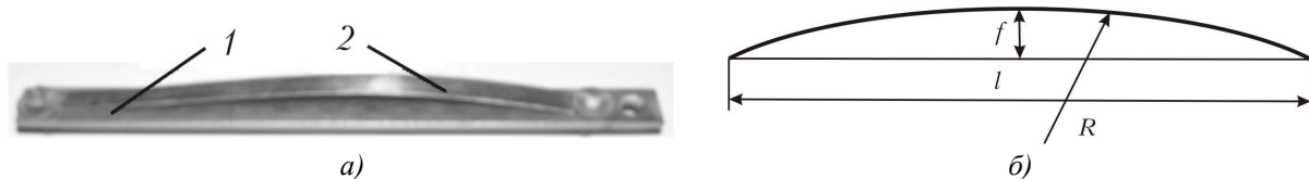
Рис. 2. Кондуктор (1) зі зразком (2): після нанесення покриття (а) і розрахункова схема обчислення радіуса кривизни R (б)
