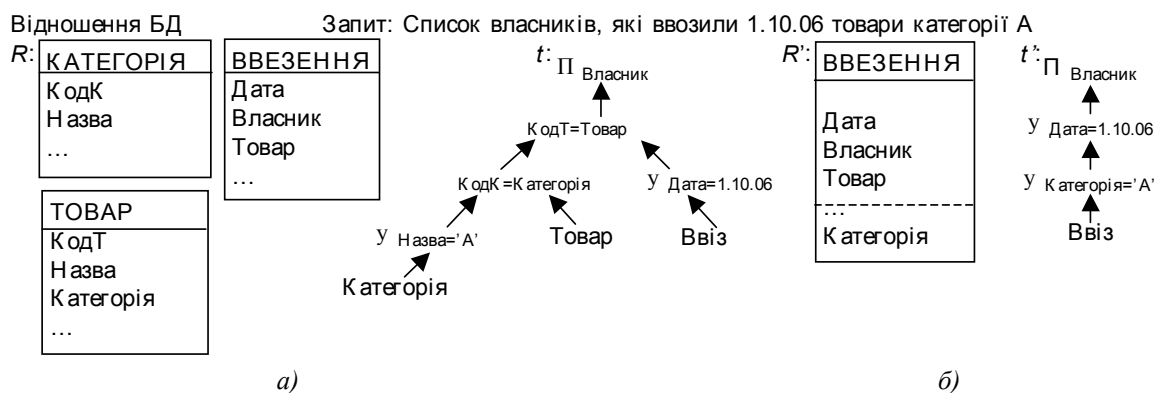
Рис. 2. Приклад БД і дерев реляційної алгебри для запиту до (а) і після (б) денормалізації
