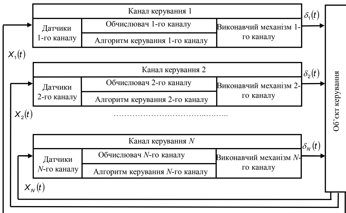
Рис. 1. Структура традиційних систем автоматичного керування
