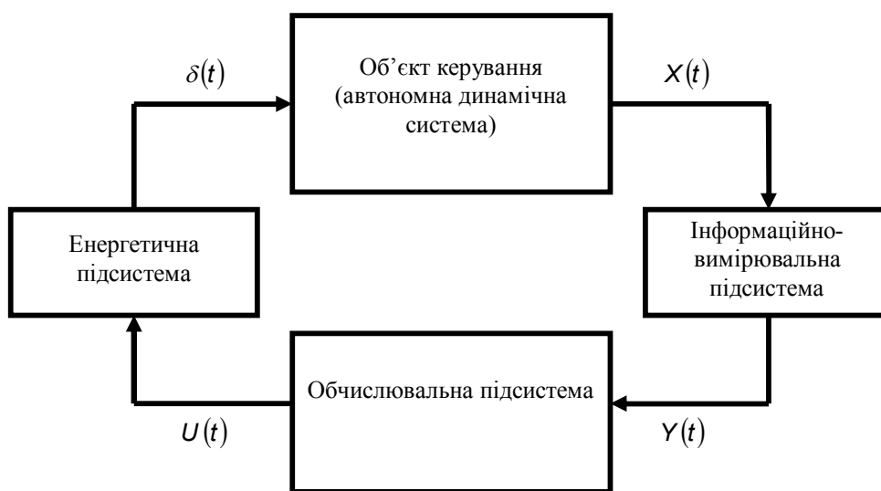
Рис. 2. Структура бортового інформаційно-керуючого комплексу
