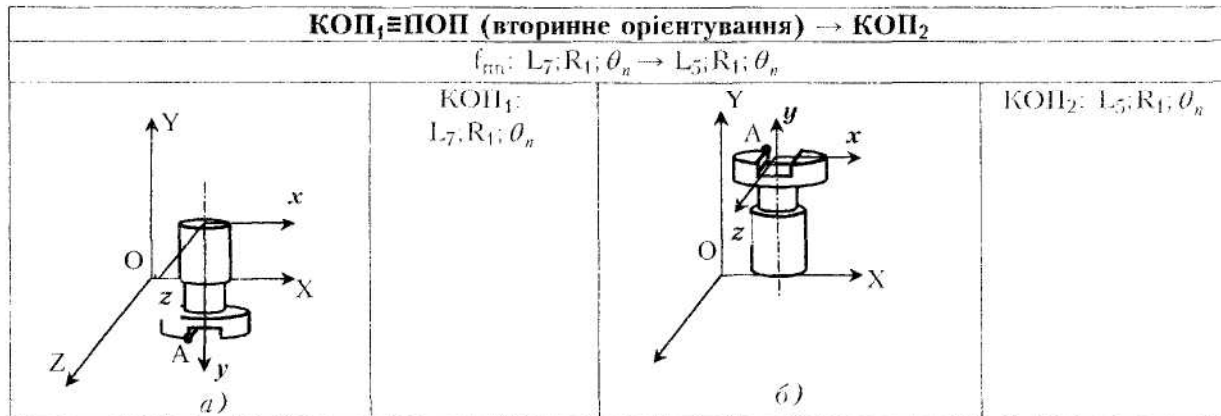
Рис. 4. Приклад формалізації підфункції f_{mn} при переведенні ОВ із КОП 1 у КОП 2 : а) КОП 1 , де L_7 – величина лінійних переміщень т. А вздовж осей X, Y, Z відносно системи координат ПО при переведенні ОВ із ПНП/ПОП у КОП 1 (рис. 3); R_1 – вектор направленості лінійних переміщень т. А; б) КОП 2 , де L_5 – величина лінійних переміщень т. А вздовж осей X, Z відносно системи координат ПО; R_1 – вектор направленості лінійних переміщень т. А;
