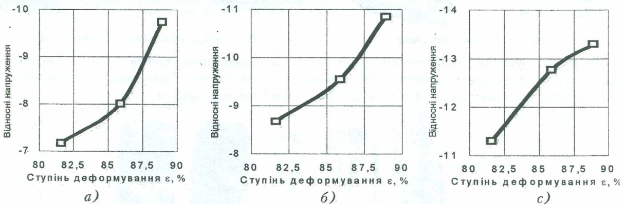
Рис. 5. Розподіл максимального відносного \sigma_{II}/\sigma_{0,2} напруження на конічній поверхні матриці
