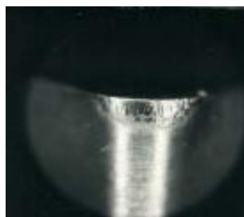
Рис. 4. Різальна пластинка силеніту–Р. Знос по задній поверхні при обробці сталі ХВГ. Режими різання: швидкість різання ( V ) – 1,0 м/хв; подача ( S ) – 0,1 мм/об; глибина різання ( t ) – 0,25 мм.
