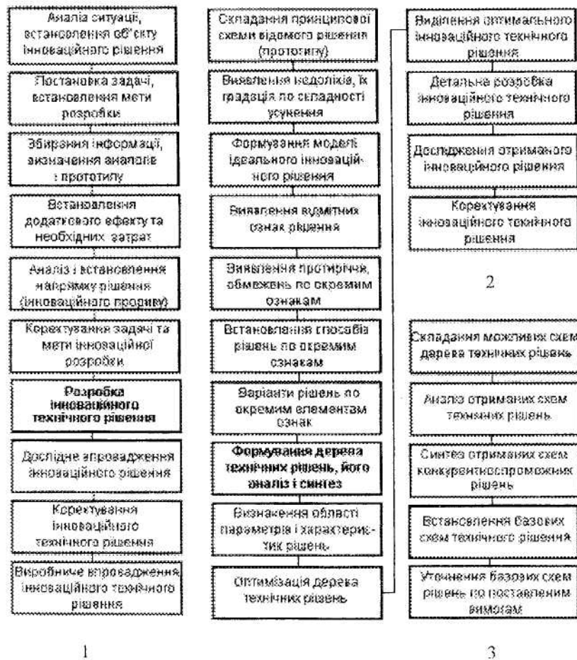
Рис. 2. 1 – загальна блок схема виявлення, розробки і впровадження інноваційного технічного рішення; 2 – блок схема розробки інноваційного технічного рішення; 3 – схема формування дерева технічних рішень
