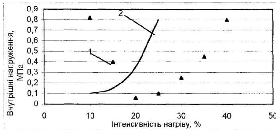
Рис. 2. Залежність внутрішніх напружень від інтенсивності нагріву (1 – експериментальні дані, 2 – теоретичні розрахунки)
