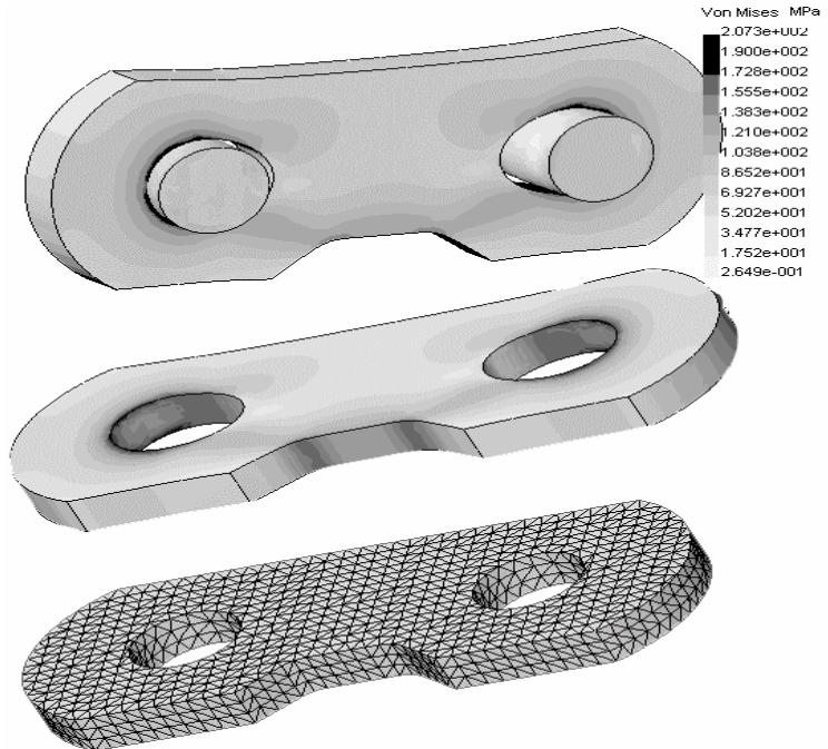
Рис. 1. Збільшення областей пластичної деформації при збільшенні навантажень
