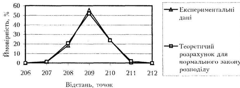
Рис. 3. Розподіл результатів вимірювання відстані по горизонталі (математичне сподівання 209,04, середньоквадратичне відхилення 0,71, розмір зображення 640×480 точок, попередній запис зображення на магнітну стрічку)
